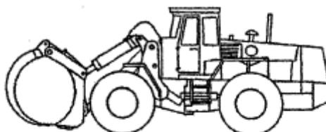
Esempio di caricatore a ruote con pinza
